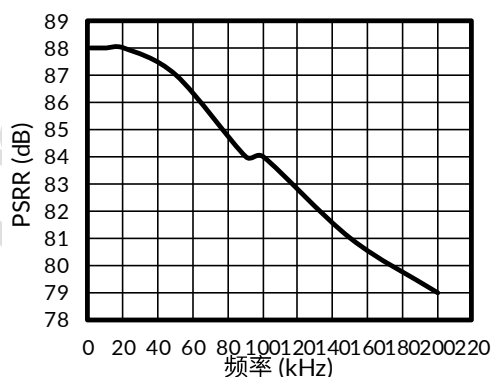
图 32. 电源抑制比 (PSRR) 与频率的关系
